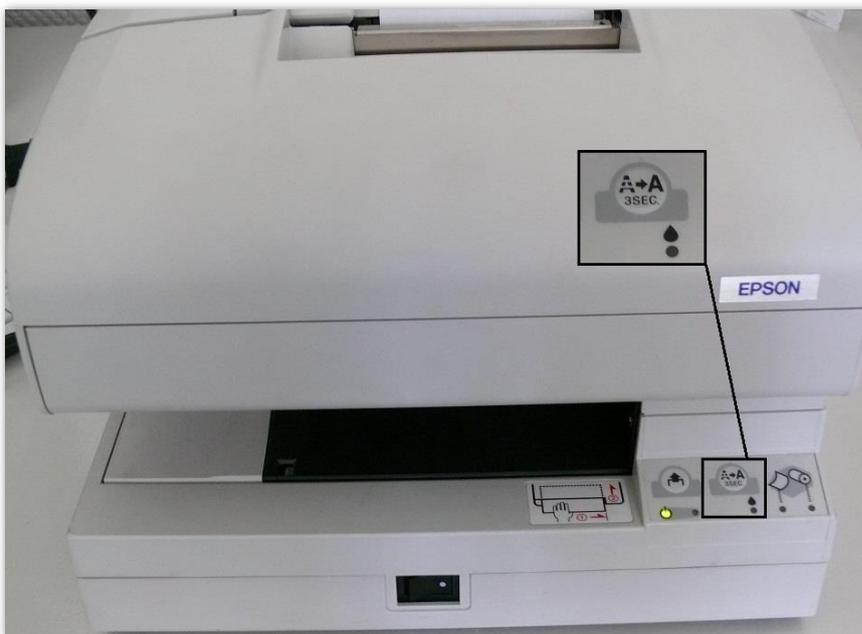
**Tip:** Stellen Sie fest, dass der Ausdruck Streifen zeigt, kann dies an einem verschmutzten Druckkopf liegen. Um das Problem zu beheben, halten Sie die Taste **A→A** in der Mitte (siehe Abbildung) 3 Sekunden lang gedrückt. Das Gerät führt nun eine Reinigung des Druckkopfes vollkommen automatisch durch.
