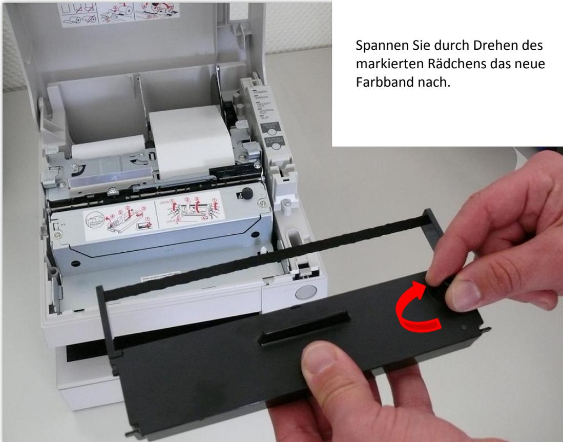
Legen Sie das neue Farbband ein und drücken Sie es leicht nach unten, bis es einrastet. Spannen Sie nun noch einmal das Band durch Drehen des markierten Rädchens nach und schließen Sie das Gehäuse. Der Drucker ist nun wieder einsatzbereit.
