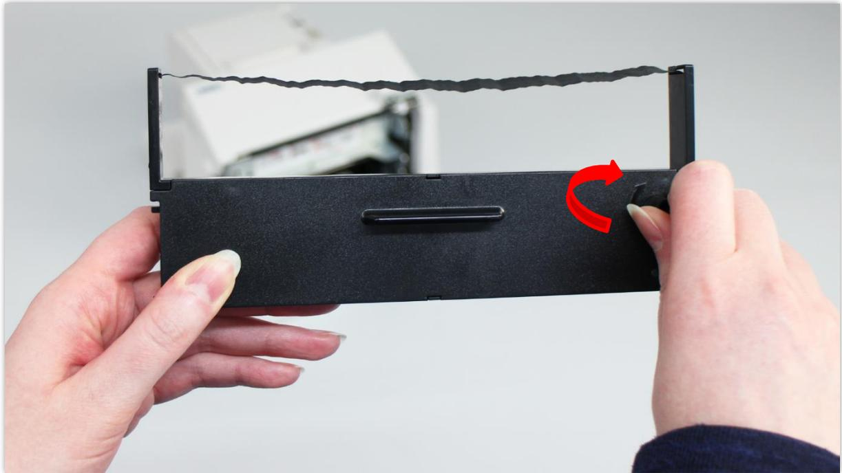
Legen Sie das neue Farbband vorsichtig wie abgebildet ein. Spannen Sie nun noch einmal das Band durch Drehen des markierten Rädchens nach und schließen Sie das Gehäuse. Der Drucker ist nun wieder einsatzbereit.
