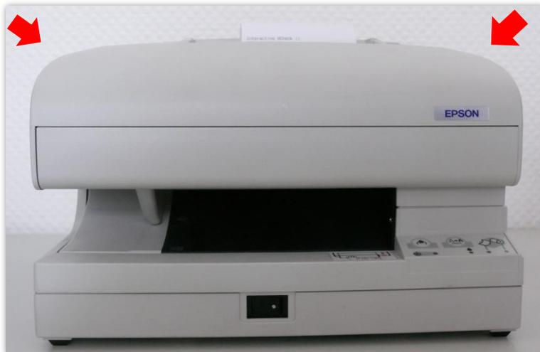
Durch Ausschalten des Druckers kann Luft in das Drucksystem gelangen. Dies äußert sich durch ratternde oder krachende Geräusche des Druckers nach dem Einschalten. Indem Sie den Drucker während dem gesamten Wechselvorganges **nicht** ausschalten, kann das Ansaugen von Luft ganz einfach vermieden werden.
