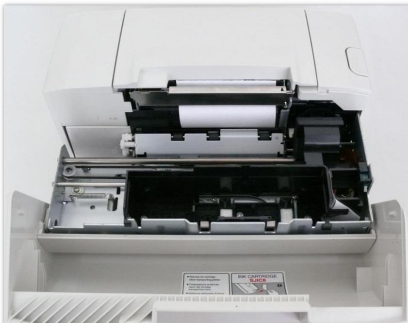
Entfernen Sie die Schutzfolie auf der Ersatzpatrone und setzen Sie diese wie abgebildet in das Gerät ein.
