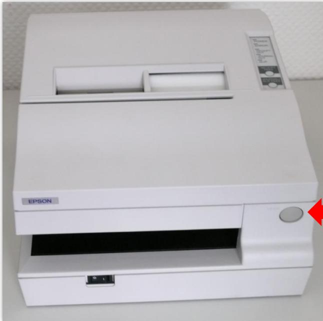
Öffnen Sie die Abdeckung des Druckers mit Hilfe des markierten Knopfes und entfernen Sie das alte Farbband.
